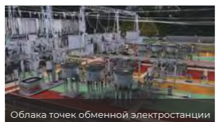
Облака точек обменной электростанции
