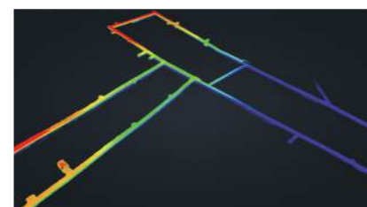
Облака точек выработки шахты
